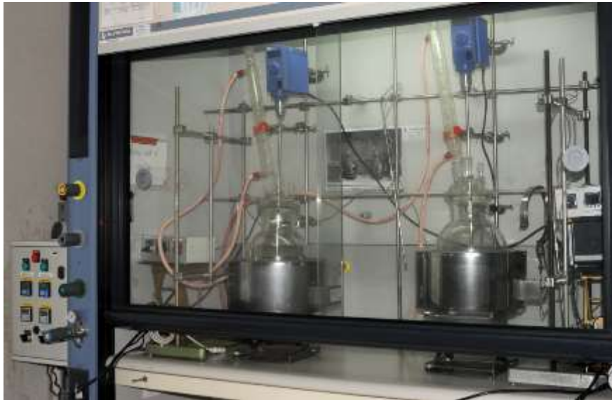
Figure 63 – Essai de vieillissement d'huile dans des ballons.
