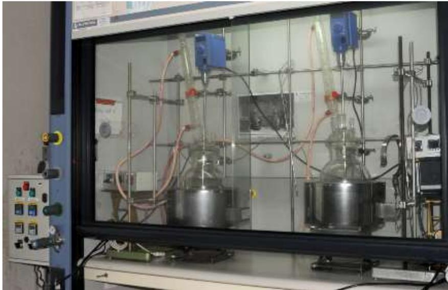
Figure 63 – Essai de vieillissement d'huile dans des ballons.
