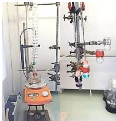
Photo 1 : montage expérimental pour la fonctionnalisation/complexation.
