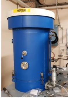
**Figure 37 Four de frittage (à tube en tungstène) du laboratoire  $UO_2$  – T maximale du four=1700°C,  $pO_2$  limitée par l'équilibre  $WO_2/W$**
