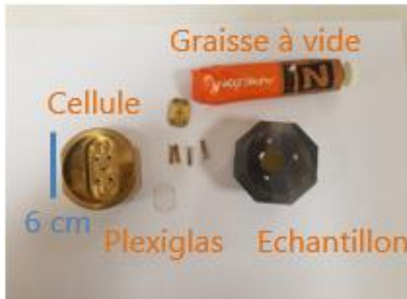
Figure II.18. Photo de la préparation d'un échantillon dans la cellule adaptée avec des lames de plexiglas.
