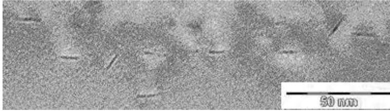
Figure 7: Vue « sur la tranche » d'une population de platelets observée en condition hors Bragg et lorsque la lentille objectif est défocalisée.
