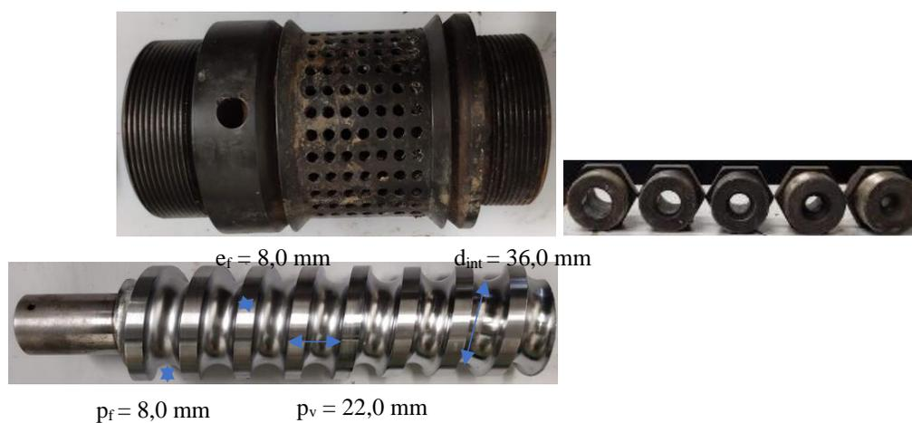
Figure 3-4 : Accessoires de la presse Komet utilisés lors de ces travaux de thèse. (Gauche) Fourreau, (Droite) filières de 15 à 6 mm de diamètre interne de la gauche vers la droite et (Bas) vis.
