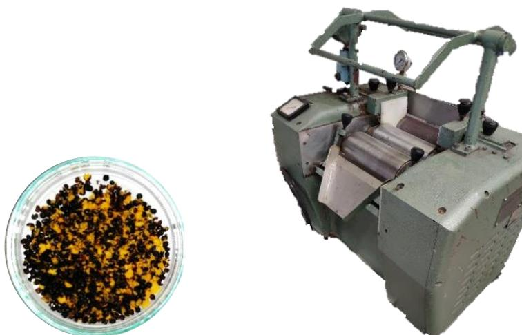
Figure 3-2 : Photo des flocons de colza après aplatissage (gauche) à l'aide de l'aplatisseur à rouleaux rotatif Grenier (droite)
