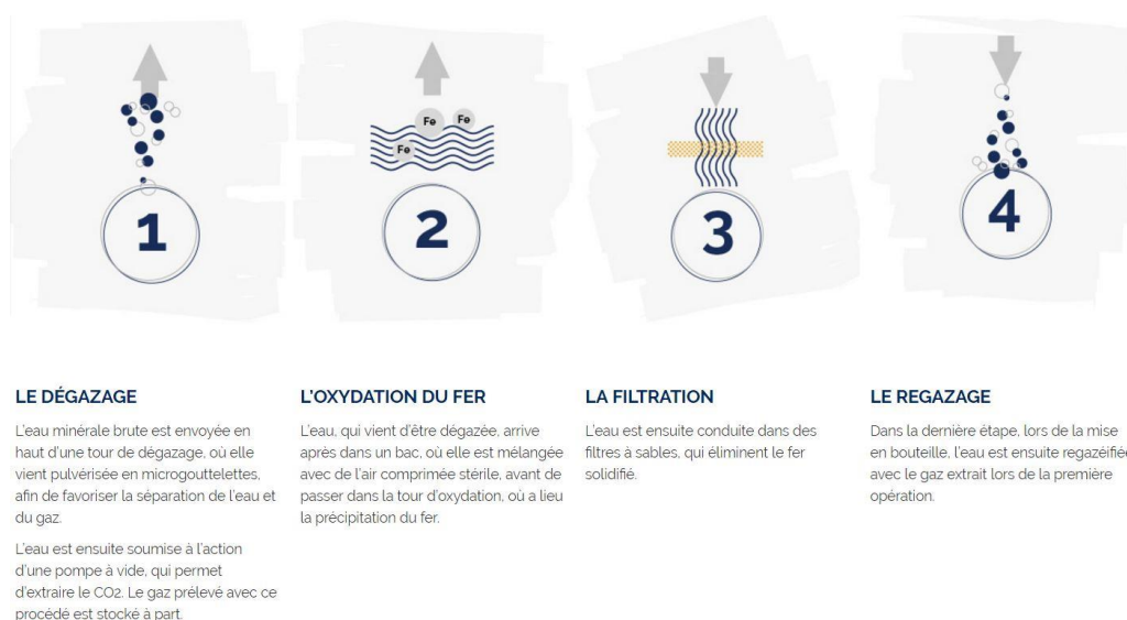
Figure 36 : Process industriel avant embouteillage. Exemple de l'EMN Orezza (Orezza)
