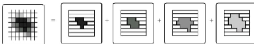
Figure I-6. Illustration de la technique step-and-shoot (d'après [36]).
