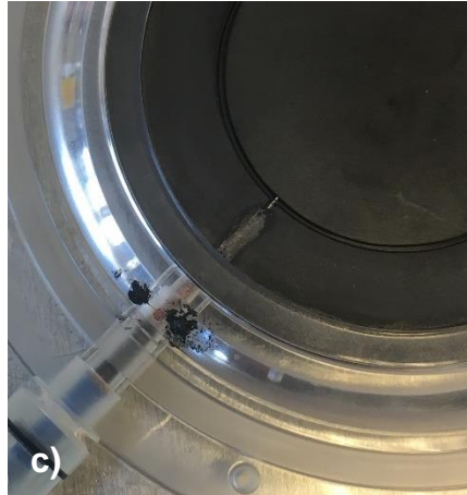
Figure II-9. a) Passage du câble triaxial. b) Collage électrique du conducteur dans l'électrode centrale et de la tresse de masse dans l'électrode de garde et c) ajout de la résine conductrice sur la tresse de haute tension (1 brin à droite et à gauche) pour assurer la conduction avec l'électrode externe et collage de l'anneau isolant.
