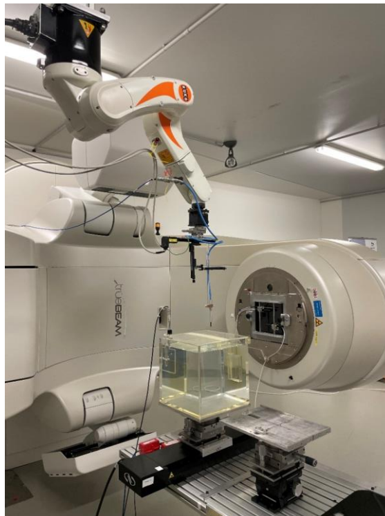
Figure II-18. Robot KUKA fixé au plafond du bunker avec une chambre d'ionisation en place en configuration dite d'étalonnage.
