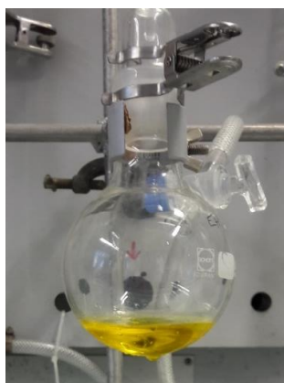
Figure 101 : Aspect du produit obtenu après retrait du solvant par réaction du dichlorure de zirconocène et de TEA, ici sous rampe vide-argon
