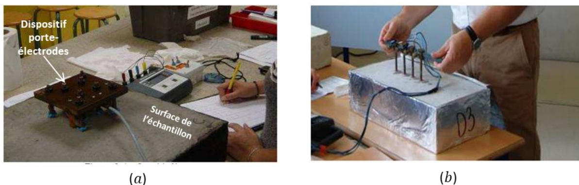
Figure I.3. Versions de la configuration quadripôle : (a) quadripôle carré [Sirieix et al. (2002)] (b) Sondes Wenner [Wenner (1915), SENSO (2009)].
