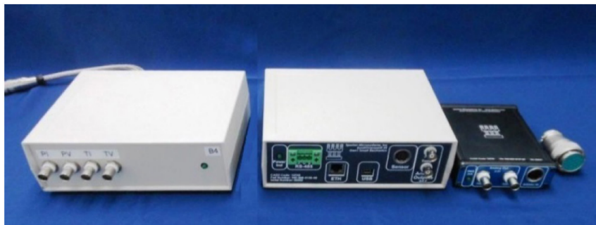
FIGURE 4.3 – Boîtiers électroniques pour l'aviation : de gauche à droite évolution des itérations d' "interrogateur smart" [151].
