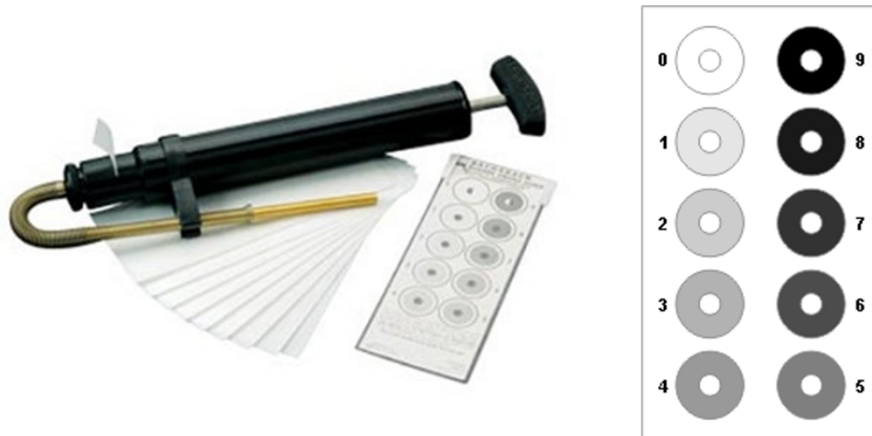
FIGURE 1.6 – Echelle de Bacharach pour la mesure de fumée.
