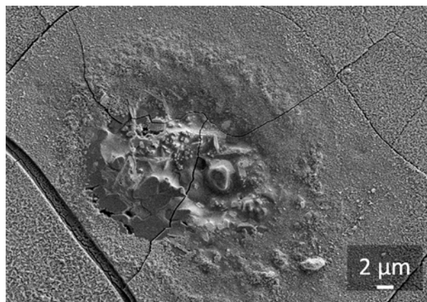
Figure 108 : Cliché MEB en vue de dessus d'un revêtement composite YAG :Ce/ZnO obtenu après croissance hydrothermale de la phase ZnO sur sous-couche de précurseur de YAG :Ce et post-calciné à 1100°C pendant 4h.
