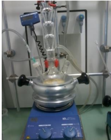
Figure 70 : Photographie du dispositif expérimental de synthèse du sol YAG :Ce 3+ par voie sol-gel.
