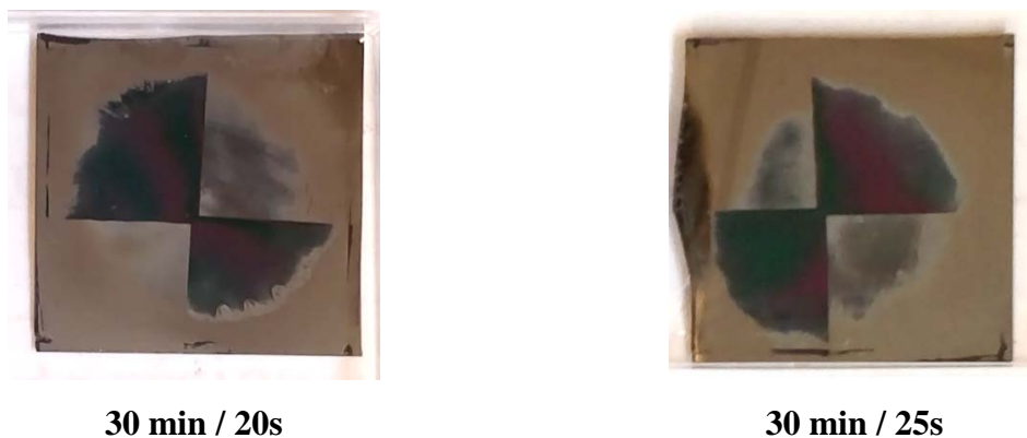
Figure 31 : Observations macroscopiques après croissance des NFs en fonction des durées de prétraitement / lavage.
