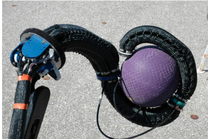
FIGURE 1.5 – Le robot inspiré des tentacules de pieuvres présenté dans [McM+06]. Celui-ci peut agripper efficacement les balles en s’enroulant autour.
