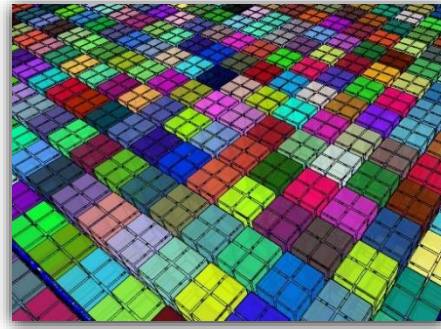
Figure II.33 : Exemple de topologie complexifiée sur les faces (ajout de 4 faces dans une face) à partir de la topologie de base.
