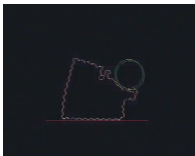
Figure I.29: Déformation d'un cube plastique. Le « contour mécanique » visualisé est obtenu par un lancer de masses sur le modèle physique (Rifai et al., 1996)
