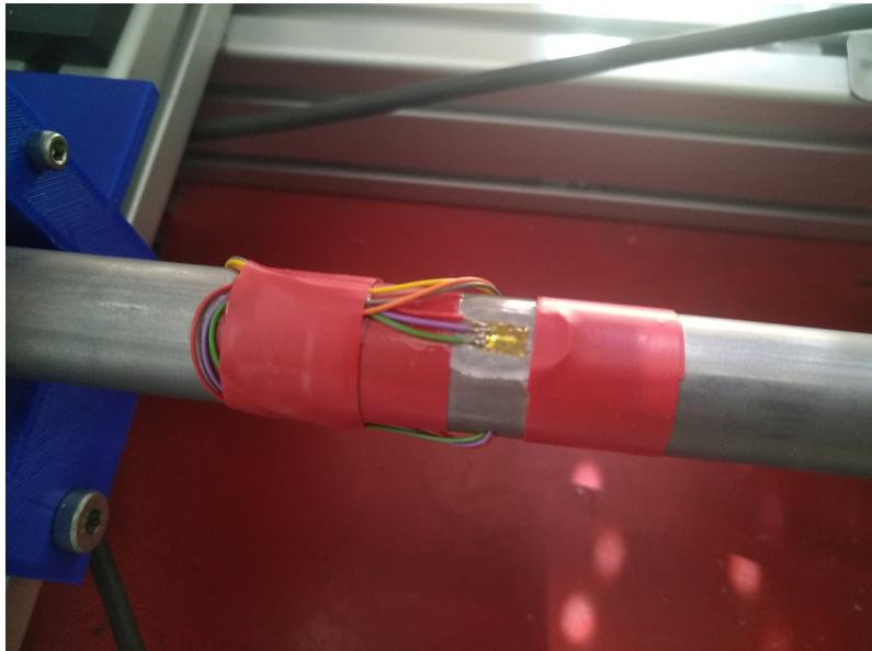
FIGURE 4.6 – Montage des jauges sur l'arbre en torsion
