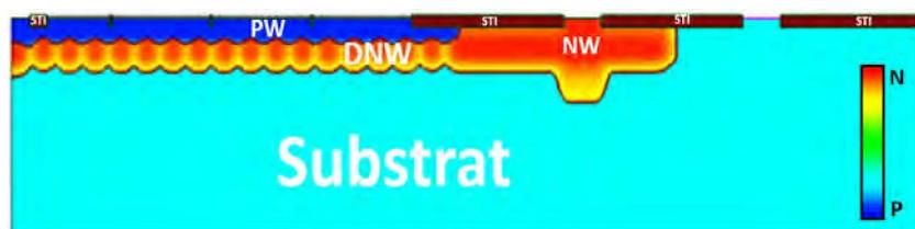
FIGURE 4.9 – Cartographie TCAD des niveaux de dopage d'une structure FD-SOI avec structuration du caisson DNW pour  $D$  et  $a$  inférieurs à leurs valeurs minimales
