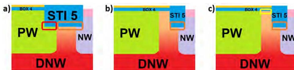
FIGURE 5.17 – Schémas des structures avec report STI et définition des défauts selon la description *RegionInterface* avec en a) la référence, en b) le report STI de  $2\mu\text{m}$ , et en c) le même report STI mais avec ajout de défauts à l'interface BOX/DNW rétrograde
