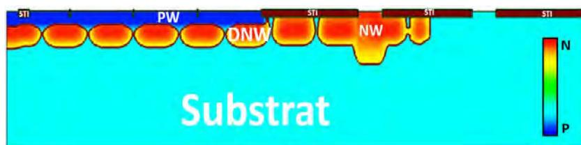
FIGURE 4.7 – Cartographie TCAD des niveaux de dopage d'une structure FD-SOI avec structuration du caisson DNW pour  $D$  supérieur à la limite et  $a$  inférieure à sa valeur minimale mais proche de cette dernière
