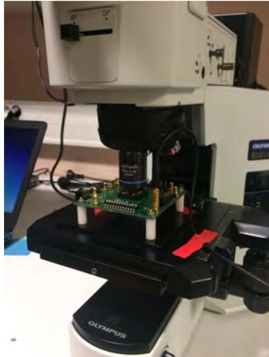
FIGURE 2.31 – Photo du montage pour la cartographie d'électroluminescence
