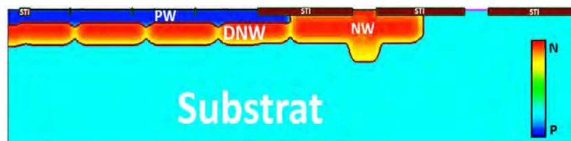
FIGURE 4.8 – Cartographie TCAD des niveaux de dopage d'une structure FD-SOI avec structuration du caisson DNW pour D élevé et a inférieure à sa valeur minimale
