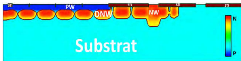
FIGURE 4.7 – Cartographie TCAD des niveaux de dopage d'une structure FD-SOI avec structuration du caisson DNW pour D supérieur à la limite et a inférieure à sa valeur minimale mais proche de cette dernière
