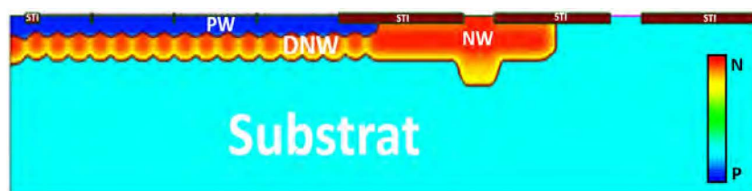
FIGURE 4.9 – Cartographie TCAD des niveaux de dopage d'une structure FD-SOI avec structuration du caisson DNW pour D et a inférieurs à leurs valeurs minimales
