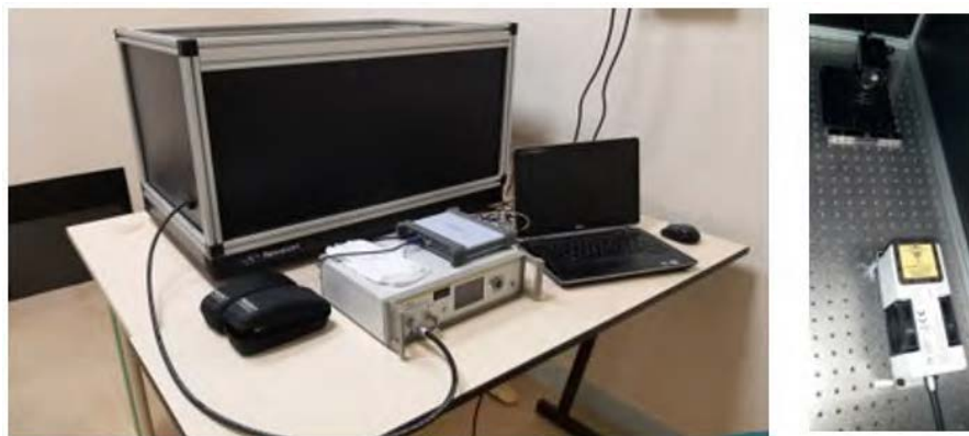
FIGURE 2.33 – Photos du montage expérimental pour déterminer le jitter
