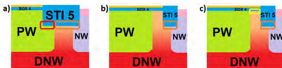
FIGURE 5.17 – Schémas des structures avec report STI et définition des défauts selon la description RegionInterface avec en a) la référence, en b) le report STI de 2\mu\text{m} , et en c) le même report STI mais avec ajout de défauts à l'interface BOX/DNW rétrograde
