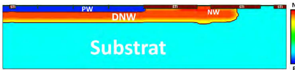
FIGURE 6.2 – Structure de la SPAD FD-SOI en sortie du bloc de simulations SPROCESS
