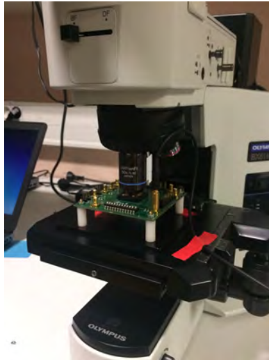
FIGURE 2.31 – Photo du montage pour la cartographie d'électroluminescence
