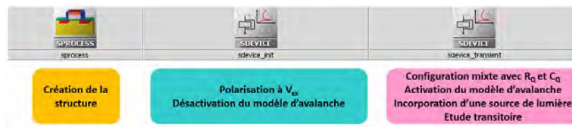
FIGURE 6.1 – Schéma du principe de fonctionnement des simulations transitoires
