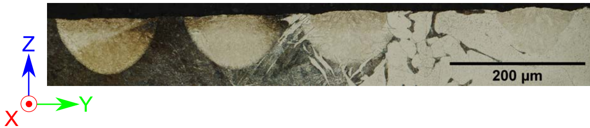
FIGURE 1.68 – Micrographie optique mettant en évidence les cordons et microstructures formés lors du lasage et révélés par une attaque au nital
