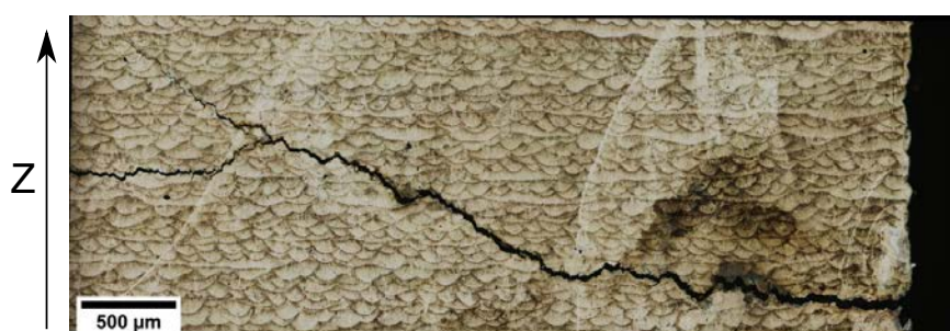
FIGURE 1.39 – Observation d'une fissure dans un échantillon de H13 provoquée par un défaut de surface. Elle se propage dans un premier temps horizontalement avant de s'orienter vers le haut de l'échantillon. Le réactif Fry A a été utilisé pour révéler les cordons. La procédure suivie pour la préparation des échantillons est détaillée dans la Section 1.2.4.
