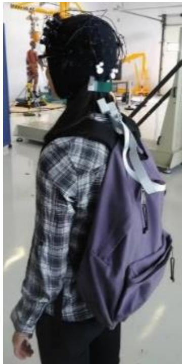
Figure 12 - Mise en place de la fNIRS
