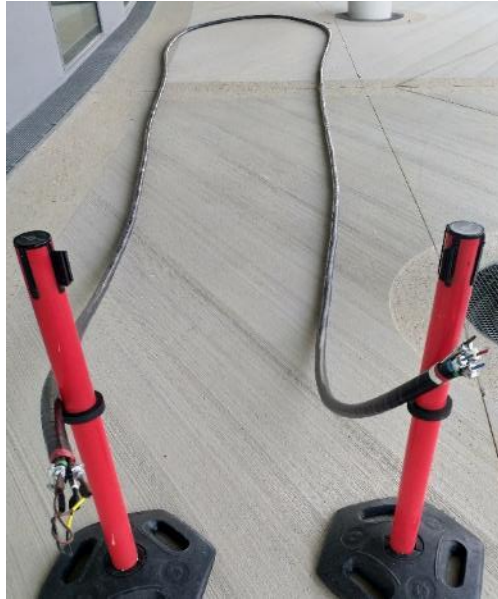
Figure 4-5 : Environnement de mesure du câble souterrain
