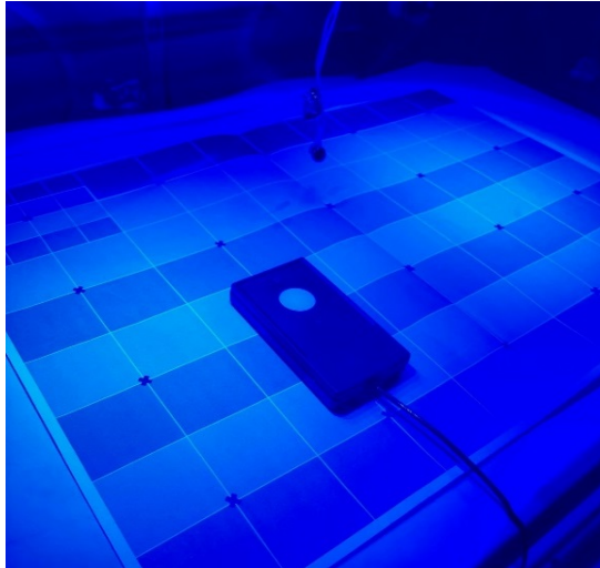
Figure 6: Représentation du photomètre placé sur la grille de mesure d'irradiance : une mesure est faite en chaque point
