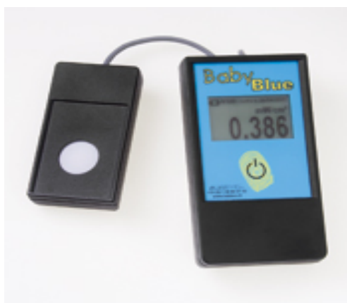
Figure 4:Radiomètre BabyBlue utilisé pour les mesures d'irradiance de la lumière bleue
