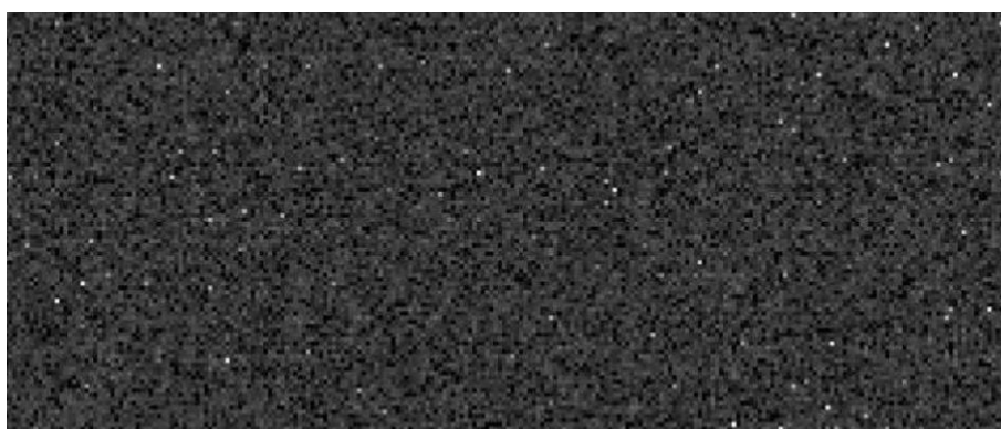
Figure 18 : Image prise avec un capteur de STMicroelectronics montrant des pixels blancs
