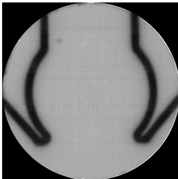
Figure 10 : Image MacroPL d'un wafer de Si contaminé au fer sur un support distinctif
