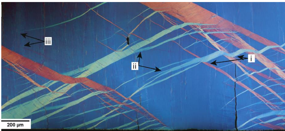
Figure 1-14 : Image optique en lumière polarisée d'un réseau de kink band dans un échantillon de Cu-Nb de 15nm. Différents éléments du réseau des kink bands sont repérés : i) intersections, ii) bifurcations et iii) fin (Nizolek et al., 2017).
