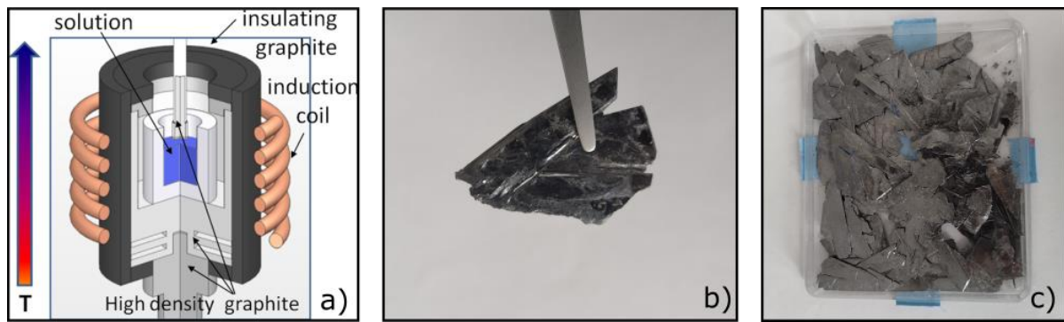
Figure 1-5 : a) Schéma du montage permettant la croissance en solution sous haute température d'après (Ouisse et al., 2013). b) Monocristaux de Cr_2AlC synthétisés par croissance en solution sous haute température. c) Exemple d'un monocristal de Cr_2AlC .
