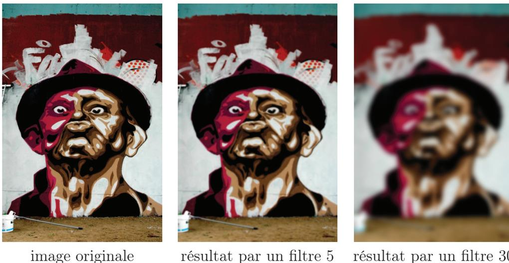
**Figure 1.3 :** Résultats de convolution d'une image par un filtre Gaussien
