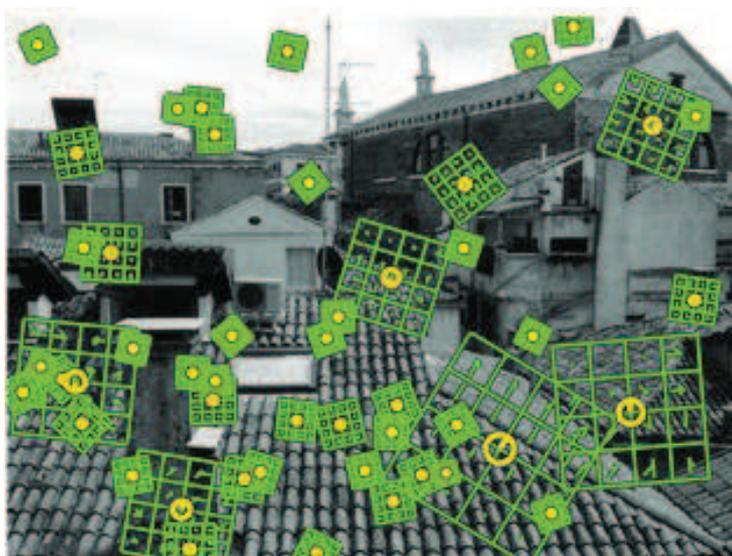
**Figure 1.17 :** SIFT : exemple de détection de point d'intérêt et de leurs descripteurs sur une image naturelle
