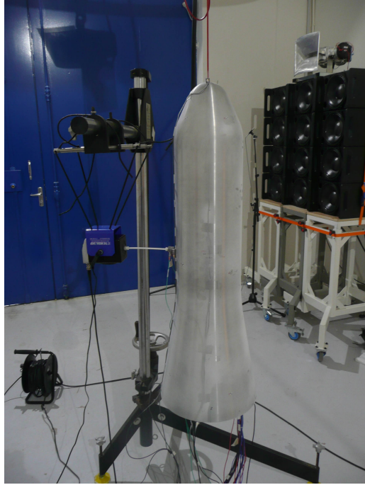
FIGURE 4.11 – Photographie du montage expérimental de la maquette HB2 soumise à une excitation mécanique aléatoire monopoint exercée par un excitateur électrodynamique.
