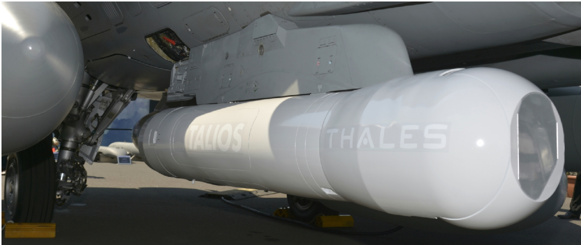
FIGURE 3.1 – Pod de désignation laser
