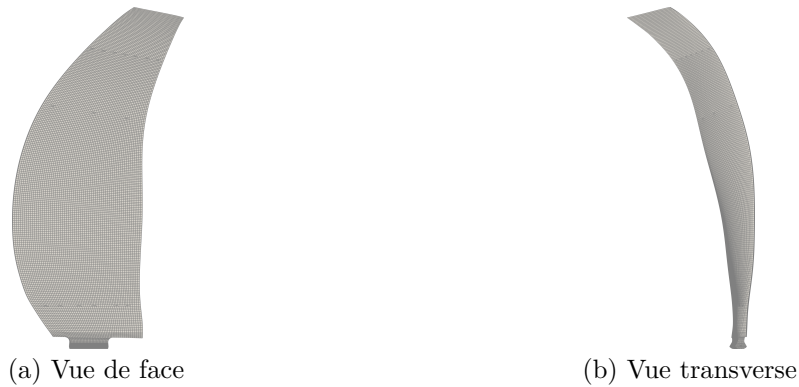
FIGURE IV.9 – Modèle aux éléments finis de la pale Open Rotor défini sur SAMCEF
