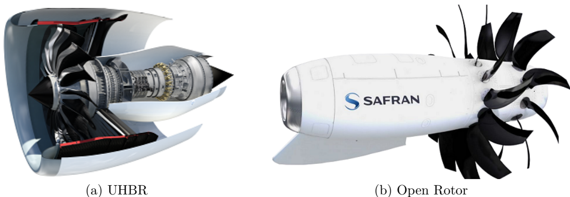
FIGURE I.6 – Futures architectures développées dans le cadre du programme Clean Sky
