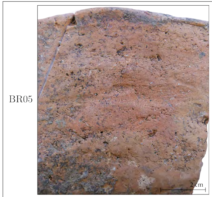
FIGURE 4.14 – Exemple d'un état de surface caractéristique du type BR05 (GeF_082).
