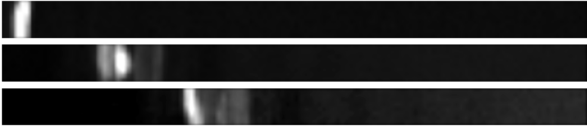
Figure 6.24 - Exemple de variation du reflet d'une mire en aluminium lors de la déflexion d'un panneau.
