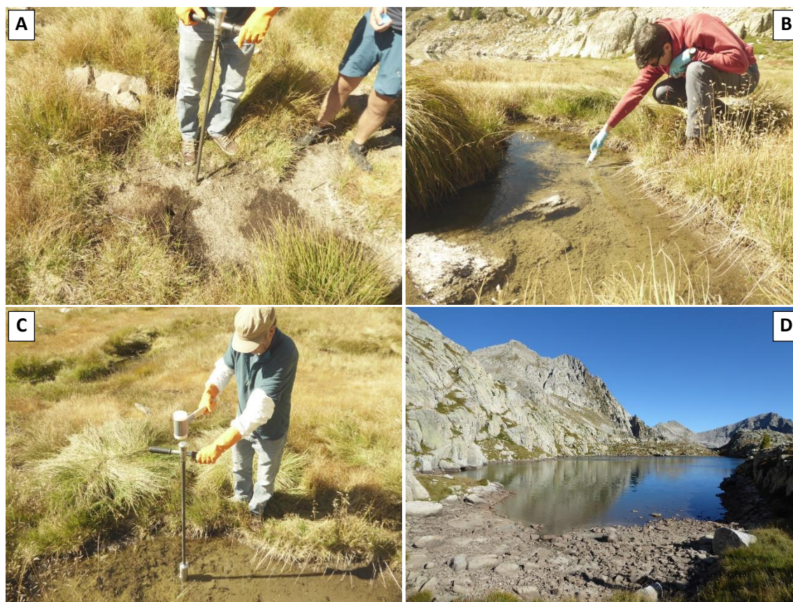
Figure II-12 – Échantillonnages de la mission NEG21. (A) Prélèvement de la carotte C1c à l'emplacement asséché de la carotte NEG18-ZH1-C1 ; (B) prélèvement d'eau dans une mare voisine (NEG21-ZH1-E4) ; (C) Prélèvement de la carotte C4b dans la même mare ; (D) Lac sud des Bresses, à l'est du lac Nègre, dans lequel de l'eau et du sédiment ont été échantillonnés.
