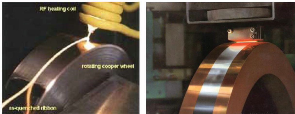
Figure I-15 Les techniques de fabrication des rubans amorphes : à gauche la technique «melt spinning » et à droite la technique « planar flow » [9], [25].
