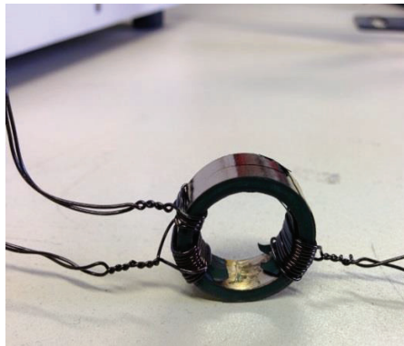
Figure IV-15 Casse totale de l'enrobage après 3109 heures de vieillissement accéléré à 200 °C
