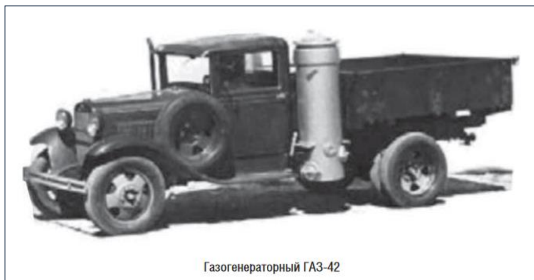
Fig.3.13. Modèle « Gaz-42 » équipé d'un gazogène
