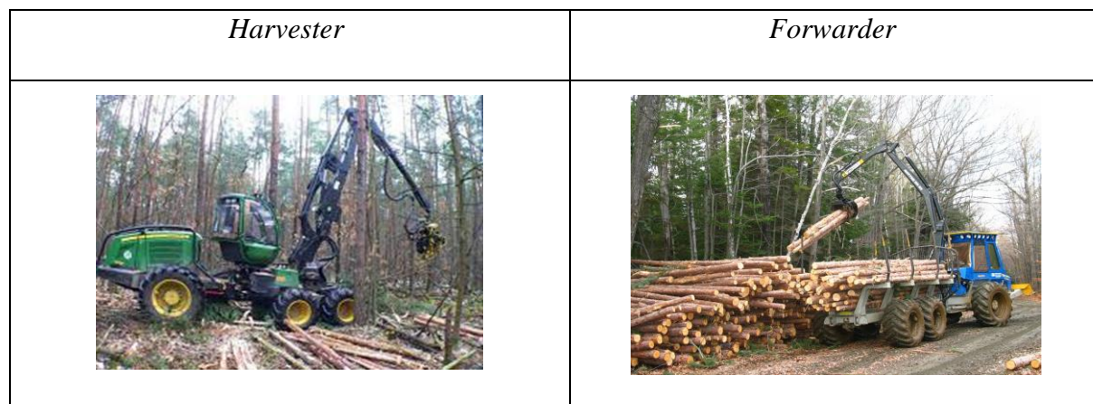
Fig.3.10. Les technologies utilisées par la méthode de débardage « en grande longueur »
