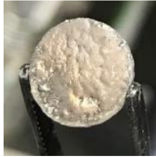
Figure III.32. Photographie d'une face d'une pastille de LLZO recouverte de lithium.
