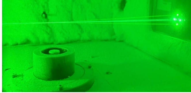
Figure 2.15 : Photo des quatre faisceaux laser LDV croisés au niveau du point focal à z=60\text{mm} au-dessus du brûleur à swirl.
