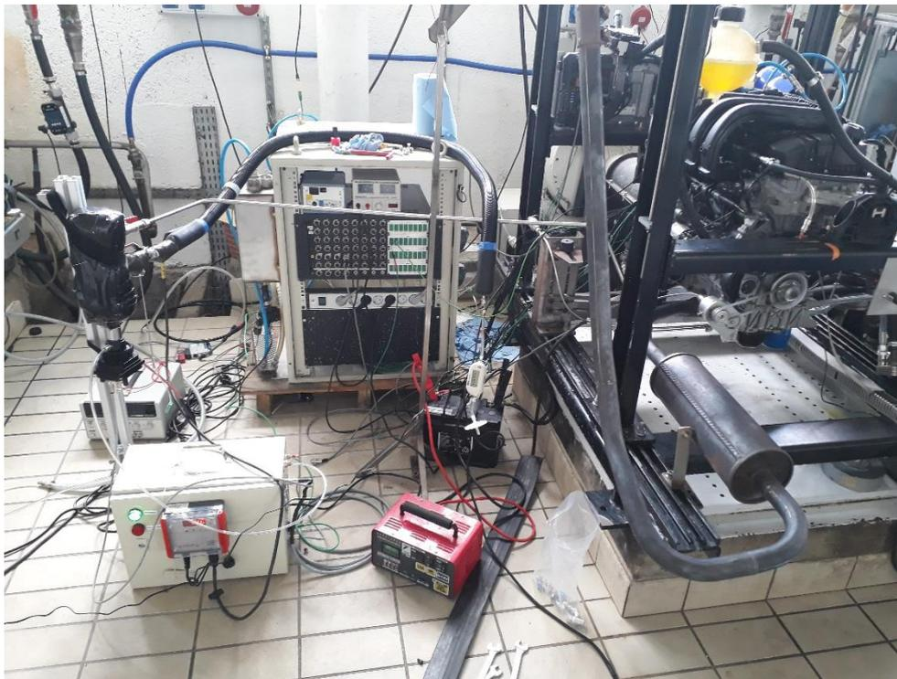
*Figure II- 3-Banc moteur EB2 atmosphérique*
