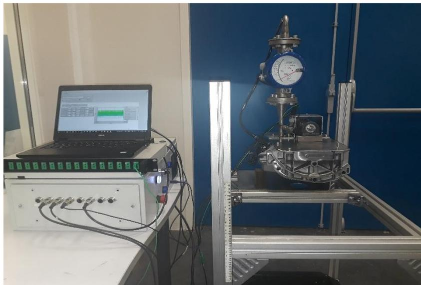
*Figure V- 8-Banc hydraulique pour filtre à huile*
