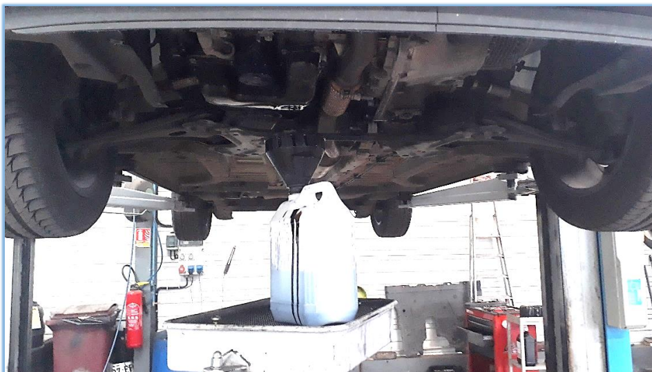
Figure V- 1-Prélèvement d'un ensemble « huile + filtre » sur un véhicule équipé d'un moteur EB2dts
