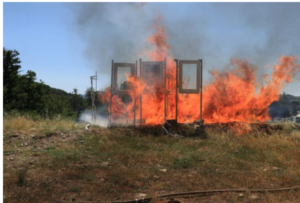
Figure 5. 20 : Photographies de l'expérience pour une configuration de feu d'interface à l'échelle du terrain à 40 s
