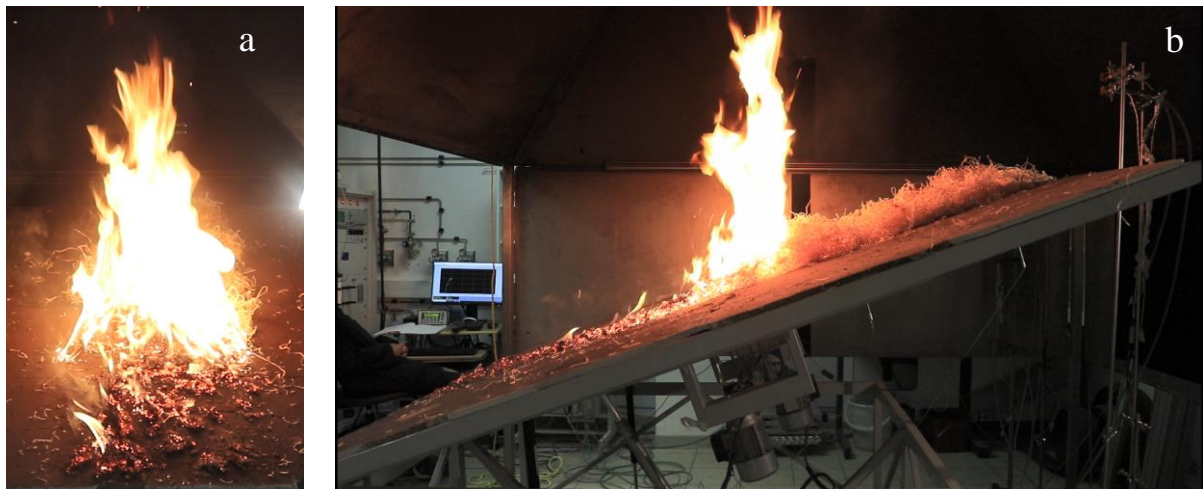
Figure 6. 1: Photographie du front de flamme pour une charge de 0,318 kg/m 2 , 40 s après l'allumage a) avec la caméra 1 et b) avec la caméra 2
