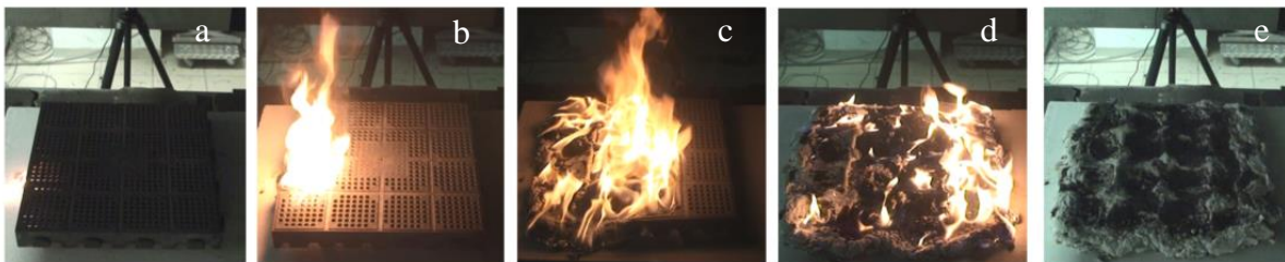
Figure 4. 19: Photographies de la combustion de la dalle en thermoplastique a) pendant la phase d'allumage ( t= 8 \text{ s} ), b) durant la phase de propagation ( t=240 \text{ s} ), c) durant la phase de propagation ( t=660\text{s} ) d) durant la phase de petite flamme ( t= 1320\text{s} ) et e) pendant la phase de combustion dans flamme ( t=3420\text{s} )
