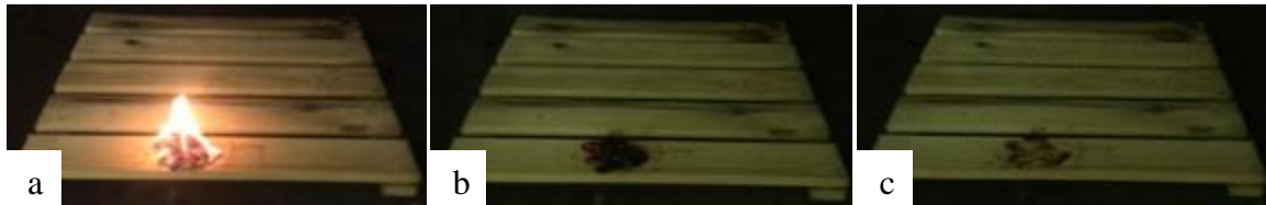
Figure 4. 8: Brandons de la sous-classe C14 placés en tas sur la surface de la dalle en bois (position PB1) a) instant du dépôt t = 0 s, b) extinction totale des brandons après 88 s et c) après le retrait des brandons
