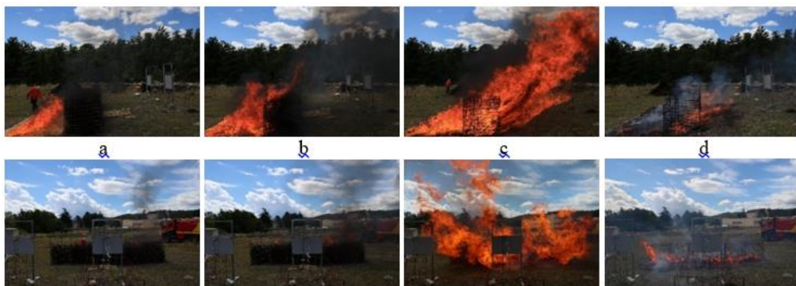
Figure 5. 8: Essai 1 : photographies de la combustion d'une haie de 1 m de haut à l'échelle du terrain a) Propagation du feu dans la frisure de bois ( t = 1 \text{ s} ) b) Allumage de la haie ( t = 5 \text{ s} ) c) Brûlage de la haie ( t = 19 \text{ s} ) d) Brûlage des particules les plus épaisses ( t = 61 \text{ s} ).
