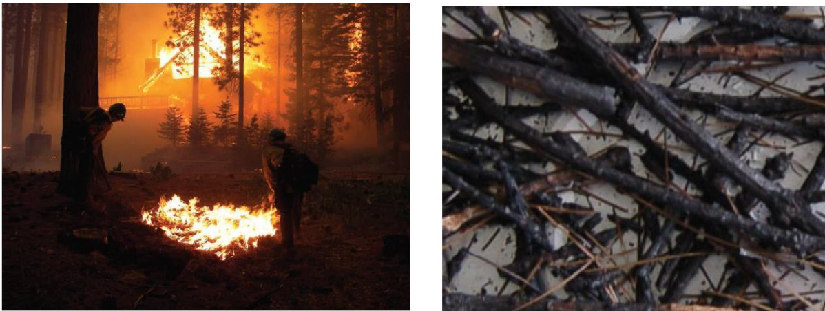
Figure 1. 6 : a) Un petit feu localisé produit par des brandons à côté d'une maison en feu [148] et b) Echantillons de brandons collectés, émis par un pin Coréen de 4,0 m [130]
