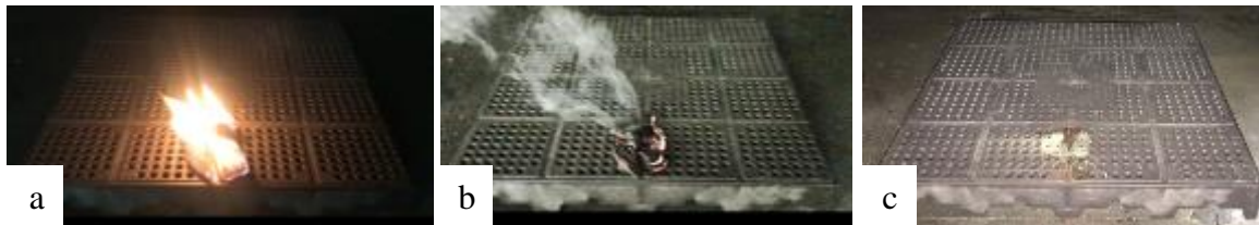
Figure 4. 9: Brandons de la sous-classe C14 placés en tas sur la surface de la dalle thermoplastique (position PT1) a) instant du dépôt t = 0 s, b) extinction totale des brandons après 180 s (fumée dégagée par le thermoplastique) et c) après le retrait des brandons
