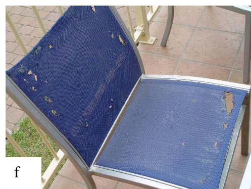
Figure 1. 9: a) Les braises ont enflammé le grenier [162], b) Goutières fondues [162], c) Allumage d'un plancher suspendu à cause des matériaux combustibles présents autour et sur le plancher [162], d) Propagation du feu à la maison par les escaliers et les poutres en bois [162], e) Chaleur rayonnante due un incendie de voiture [154] et f) Attaque de brandon sur une chaise [154]
