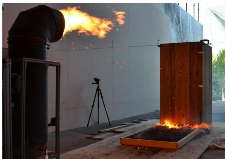
Figure 1. 10 : Générateur de brandon développé par le NIST [172]
