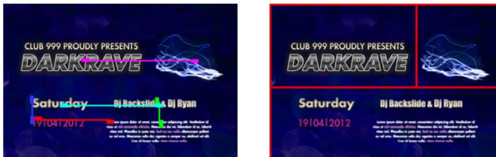
FIGURE 2.5 – Détection d’alignement (gauche) et segmentation du design en zones de texte et graphiques (droite) (O’Donovan et al. 2015)
