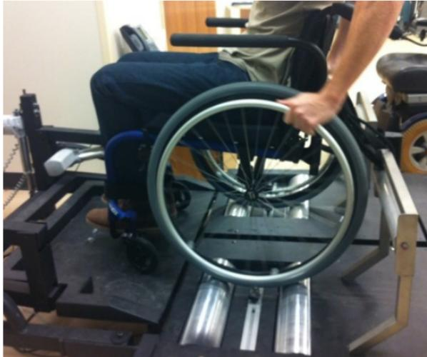
FIGURE 2.3 – Ergomètre de propulsion de Niesing et al. [17]
