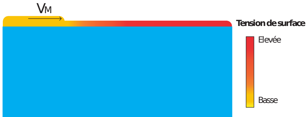
FIGURE 1.15 – Illustration de l'effet Marangoni : un flux de liquide tangent à l'interface est créé par un gradient de tension de surface, avec une vitesse V_M proportionnelle à la valeur de ce gradient.
