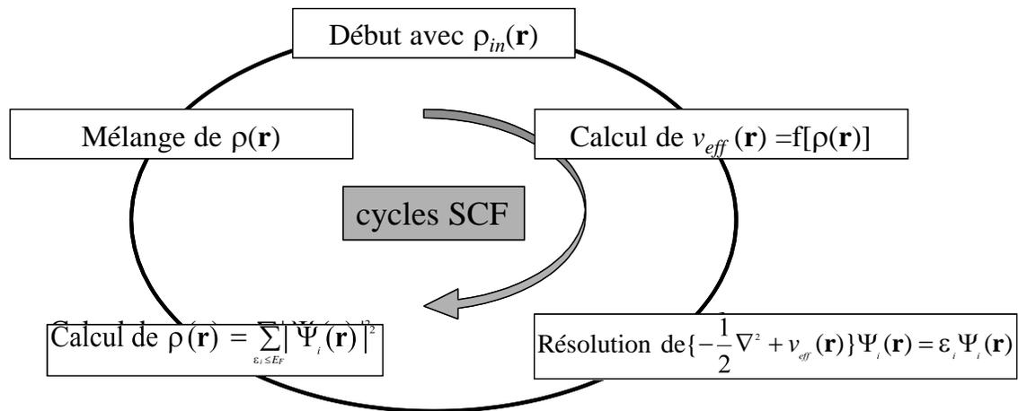
Figure 2. Cycle autocohérent lors d'un calcul DFT
