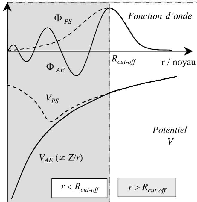
**Figure 1:** Représentation des allures générales de la « vraie » fonction d'onde  $\Phi_{AE}$  et de la pseudo-fonction d'onde  $\Phi_{PS}$  (en haut), ainsi que du « tous électrons »  $V_{AE}$  et du pseudo-potential  $V_{PS}$  (en bas).
