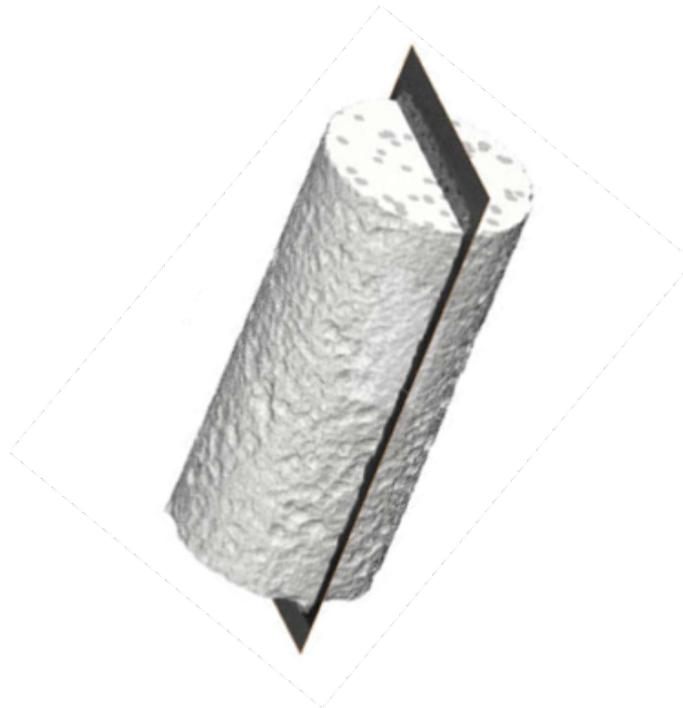
FIGURE 3.7 – Illustration de coupe réalisée pour la vérification de l'isotropie
