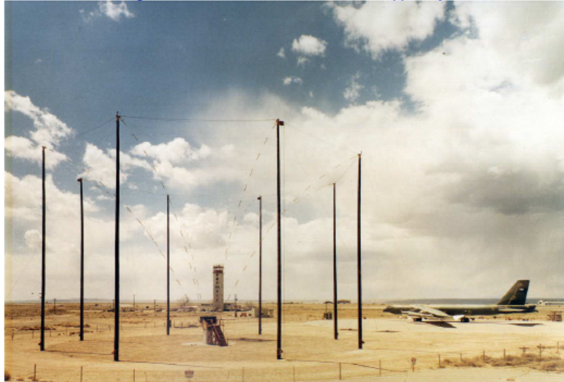
FIGURE 1.6 – Simulateur à dipôle VPD-I de l'armée américaine [26].
