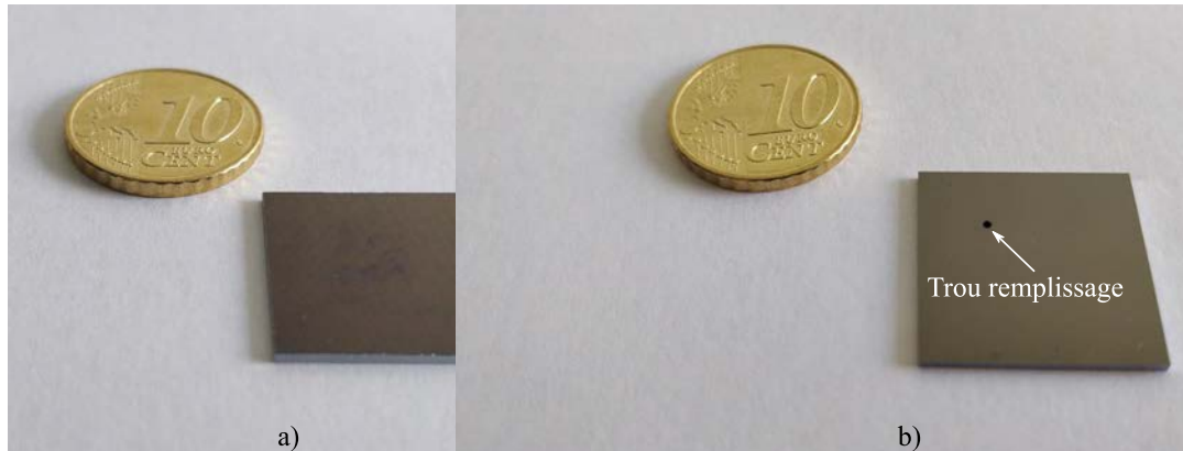
Figure 4-27 : Face avant (a) et face arrière (b) d'une chambre à vapeur après découpe en puce unitaire.
